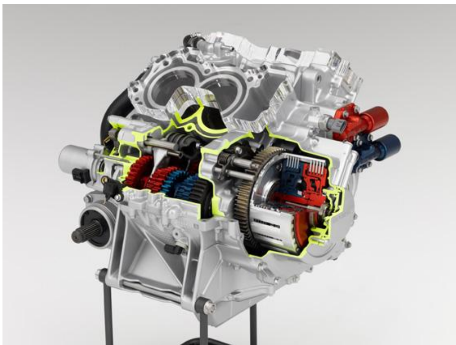
Bild 1: Das vollautomatische Doppelkupplungsgetriebe im Detail.
