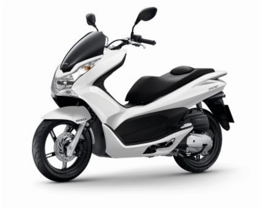
Bild 4: Der neue 125er Roller PCX glänzt mit dynamischer Optik sowie einer innovativen Leerlauf-Abschaltung, die besonders genügsamen Benzinverbrauch begünstigt.
