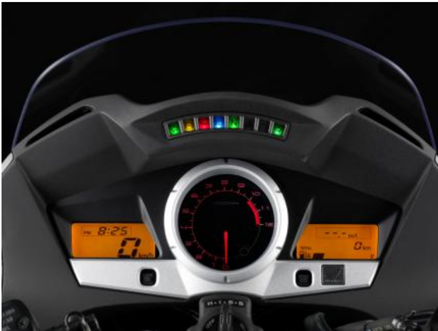
Bild 2: Ein großer analoger Drehzahlmesser bildet den optischen Mittelpunkt im modern arrangierten Cockpit der CBF1000F.
