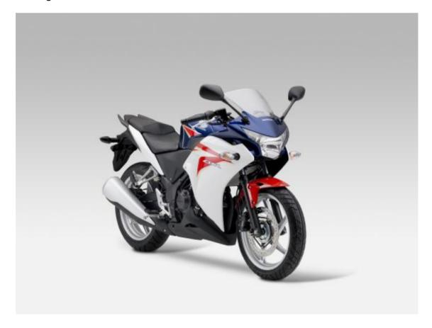
Eine sichere und immer gut kontrollierbare Straßenlage wird durch das besonders ausbalancierte Fahrwerk sichergestellt. Das Chassis der CBR250R ist eine moderne Brückenkonstruktion aus Stahl, die vorne mit einer Telegabel bestückt ist. Der Standrohrdurchmesser beträgt stattliche 37 mm. Die
