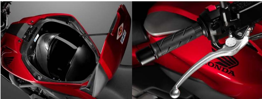
Bewährt: das Helmfach der NC700, neu: der verstellbare Bremshebel
