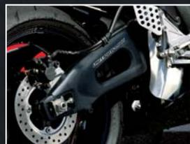
**Aluminiumschwinge** – Die ausgewogene Fahrwerksgeometrie in Verbindung mit der Unit-Pro-Link-Schwinge gewährleistet ein präzises Handling in jeder Fahrsituation.
