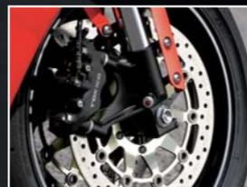
**Radial montierte Bremsscheiben vorn** – Die radial montierten High-Performance-Vierkolbenbremszangen greifen bei Bedarf auf große und dabei leichte 320-mm-Bremsscheiben und sorgen für exzellente Verzögerungswerte bei bester Kontrolle.
