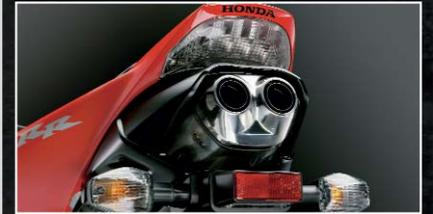
**HECS3 Katalysator** – Durch den geregelten 3-Wege-Katalysator mit Sekundärluftsystem erfüllt die Fireblade die Euro-3-Abgasnorm ohne Leistungseinbußen.
