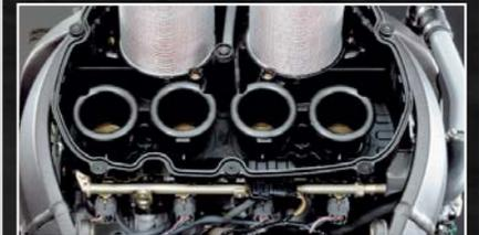
**Duale sequentielle Kraftstoffeinspritzung** – Zwei unabhängige Einspritzsysteme – eines in der Airbox und eines an den Ansaugkanälen – sorgen für blitzartiges Ansprechverhalten und knackige Leistungsabgabe über das gesamte Drehzahlband.
