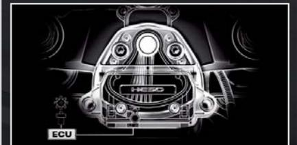
**Elektronischer Lenkungsdämpfer** – Der im Motorradserienbau einzigartige elektronische Lenkungsdämpfer (HESD) passt die Dämpfungscharakteristik automatisch an Geschwindigkeit und Beschleunigung der Fireblade an und sorgt sowohl für einwandfreie Manövrierbarkeit bei Langsamfahrt (z. B. in der Stadt) als auch für straffe, präzise Kontrolle bei der Ausschöpfung des Leistungspotenzials.
