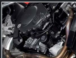
**Reihenvier mit 998 cm<sup>3</sup>** – Der starke, flüssigkeitsgekühlte Vierzylinder-Viertaktmotor mit modernster dualer sequentieller Kraftstoffeinspritzung garantiert ein besonders geschmeidiges und lineares Ansprechverhalten.
