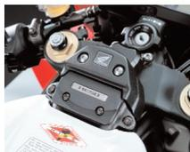
**NEW** Der revolutionäre elektronische Lenkungsdämpfer von Honda erfasst automatisch die Fahrzeuggeschwindigkeit um die optimale Dämpfungscharakteristik für eine bessere Hochgeschwindigkeits-Performance und uneingeschränkte Handlichkeit bei niedrigen Geschwindigkeiten zu erzielen.
