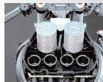
**NEW** Unter der Tankabdeckung verbergen sich der nach RC211V-Vorbild zentralisierte Kraftstofftank sowie das Luftfilter-Gehäuse, in dem die duale sequentielle Kraftstoffeinspritzung integriert ist.
