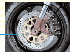
**NEW** Die extrem steifen, radial montierten High-Performance Vierkolbenbremszangen greifen auf schwimmend gelagerte 310mm-Ø-Bremsscheiben für Verzögerung auf Racing-Niveau.
