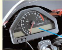
**NEW** Eine neue, leichte und vollelektronische Instrumenteneinheit mit einstellbarem Schaltblitz, großem digitalen LCD-Tachometer, Multisegment Tankanzeige, digitaler Temperaturanzeige und roter H.I.S.S.-LED informiert den Fahrer über alle wichtigen Parameter.
